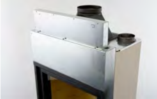
stûv 21/85 avec relevé total (configuration standard): la rehausse permet d'escamoter complètement la vitre. L'avaloir est profilé pour favoriser le tirage.
